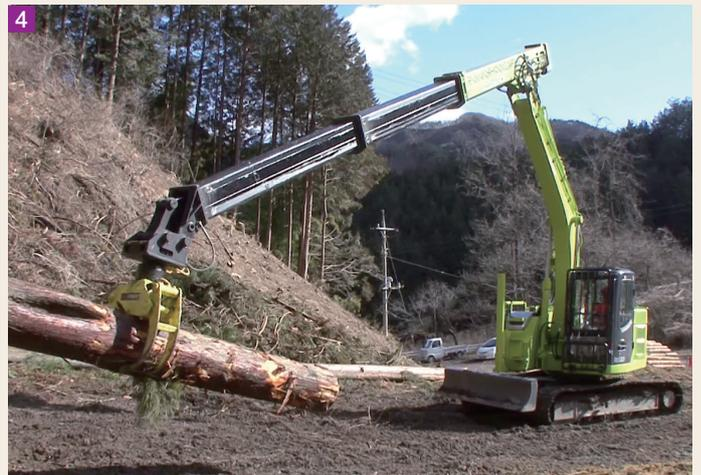
1:レンタル品のLOGSETハーベスタ 2:リース品の木材運搬用大型トラック 3:販売品のLarixLamakoトラクター型タワーヤーダ 4:自社開発の全油圧固定式ロングリーチグラブ
