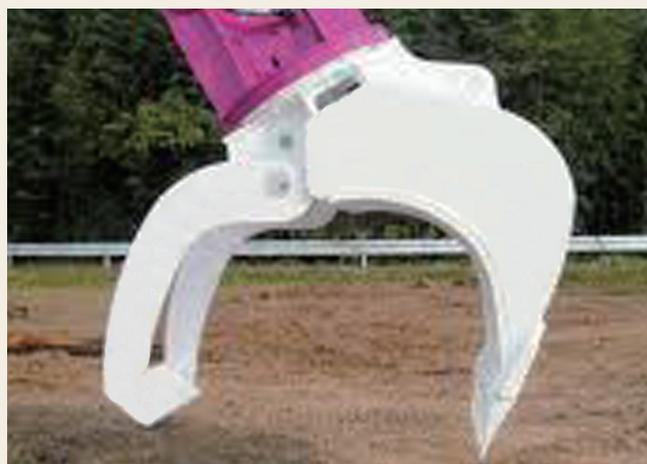
床掘や切り株に食い込むようバケット先端が鋭い形状になっています。素早い動きで路網開設時の道掘削作業の能率が向上しています。バケット側、クランプアーム内側に大きな凹面を作ることで、木材グラブに匹敵するグラブ作業が行え、生産性と生産コストの低減が図れます。スウェーデン鋼を使用した強靱なクランプアームと2モーター（25以上）による絶対ローターを搭載しています。バケット左右360度回転機能付です。
