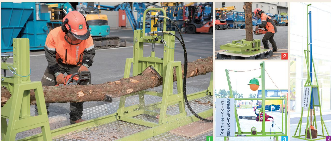
1: 風倒木伐採装置 2: 伐倒練習用丸太固定装置 3: キックバック装置 4: 木材落下衝撃装置
