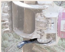
ウルトラザウルスロボに格納式の刃物を取り付けることで、立木（立竹）の伐倒作業と同時に路網作設及びグラブ作業を1台で行うことができ、作業効率が格段に向上します。
