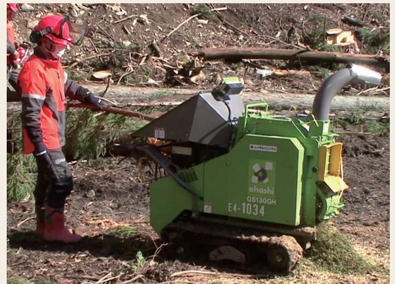
セルスタータ付で簡単に始動することができます。直径 13cm から 20cm までの丸太を粉碎できる商品を取り揃えております。もしもの時の事故防止に非常停止ボタンも付いていますので、初めてでも安心してご利用いただけます。
