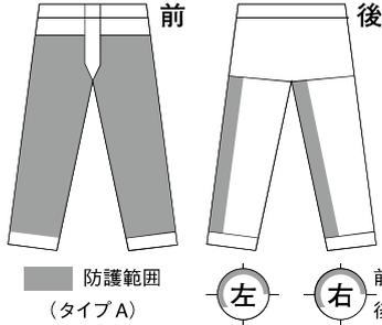
防護ズボンは、チェーンソーが布地の裏面に接触した時、防護繊維が引き出されスプロケットに絡みつくと同時にソーチェーンの回転を停止させる機能を持ちます。防護材は左記に示す灰色前の部分をカバーして
