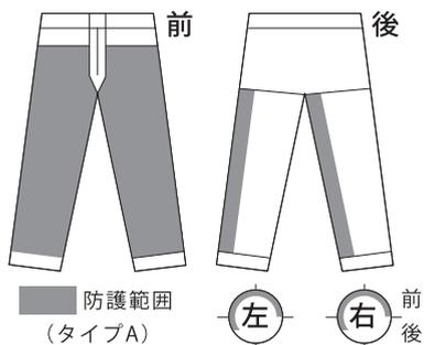
防護ズボンは、チェーンソーが布地の裏面に接触した時、防護繊維が引き出されスプロケットに絡みつくことで瞬時にソーチェンの回転を停止させる機能を持ちます。防護材は左記に示す灰色の部分をかバーしており、防護繊維やベースとなる生地等が6～9層ほどになっています。防護繊維には、ソーチェンが当たっても切れにくい強靱な化繊(アラミド繊維等)が使われています。
